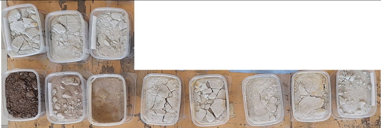
Boormonsters van spoelboring 031E0448, per meter van linksonder naar rechtsboven.
